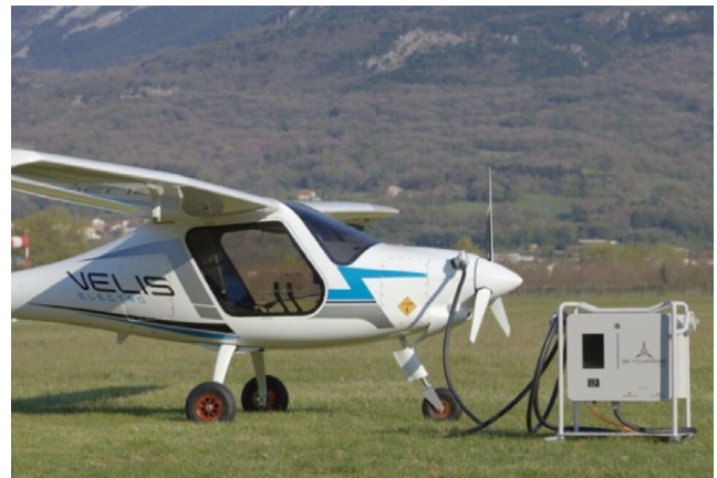
Borne de recharge pour avion électrique.
